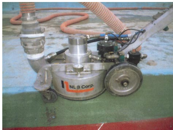
バキュームを使用。水、塗料を吸引。
